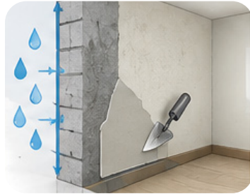
Klassische Sanierung von innen
